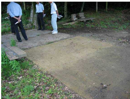
供試体を設置し、劣化状況等を確認している様子 (西都市)
