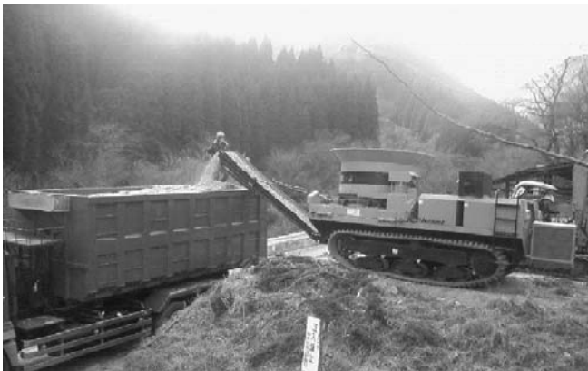
移動式破砕機とフックロール車を使用した収集運搬
