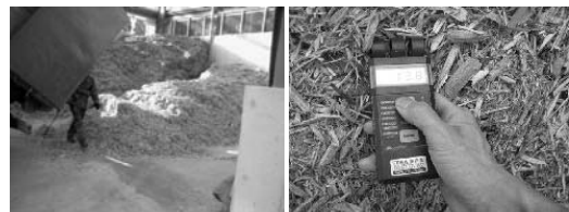
木質チップの低含水率化に向けた簡易試験
