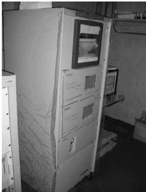
二酸化硫黄・浮遊粒子状物質 測定装置(一体型)
