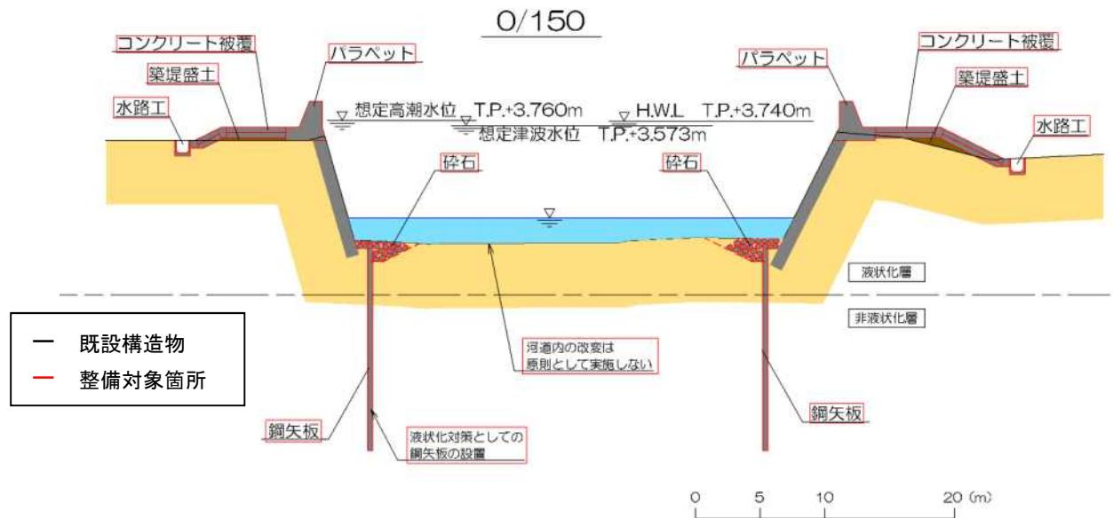
図 4-2 宮浦川河道改修断面図
