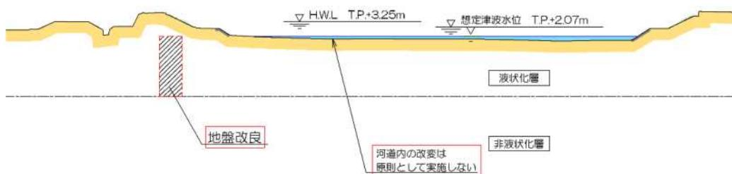
図 4-2 細田川河道改修断面図
