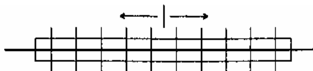
図2-1 ボルト締め付け順序
