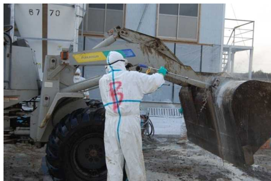
使用した重機の消毒
