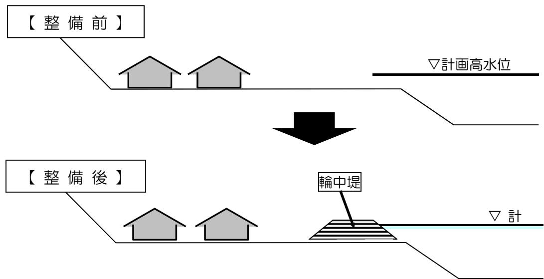
図-1 堤防（輪中堤）方式の概念図
