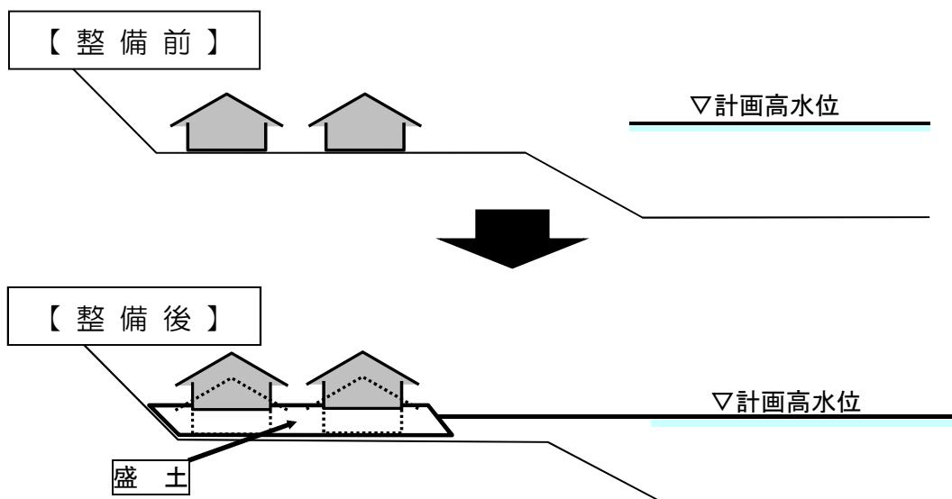
図 5-2 宅地嵩上げ方式の概念図
