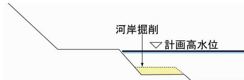
図 5-3 日之影地区五ヶ瀬川の河岸掘削概念図
