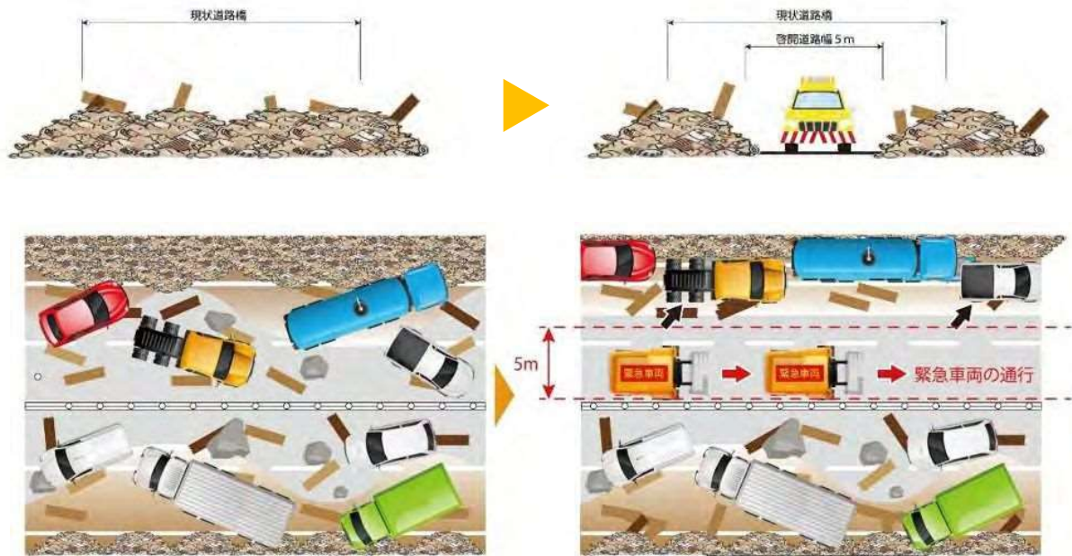
図 14 道路啓開前後の道路状況イメージ
