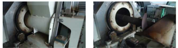
図2 開発した排蒸装置を容易に取り出すことのできる機構
