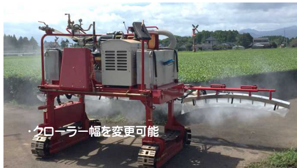
(写真)：みやざき版少量農薬散布機
