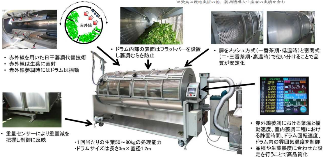
図2 開発した萎凋機の構造
