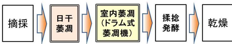
図1 日干萎凋処理を導入した新しい紅茶製造法
