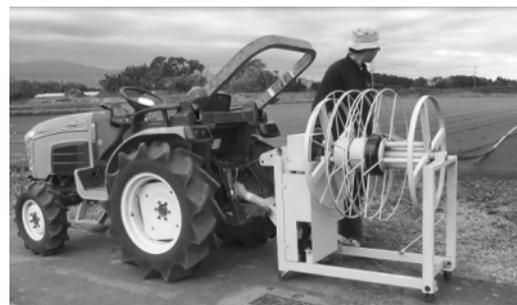
散水チューブ動力巻取機
