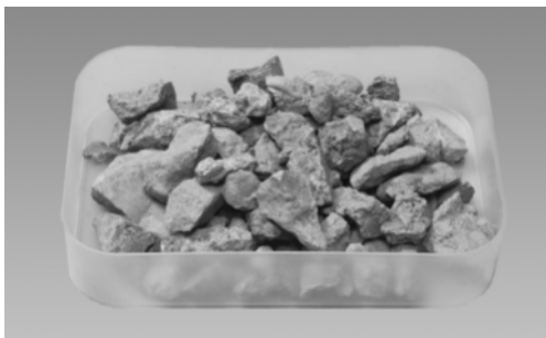
再生クラッシャーラン（がれき類を破碎したもの）
