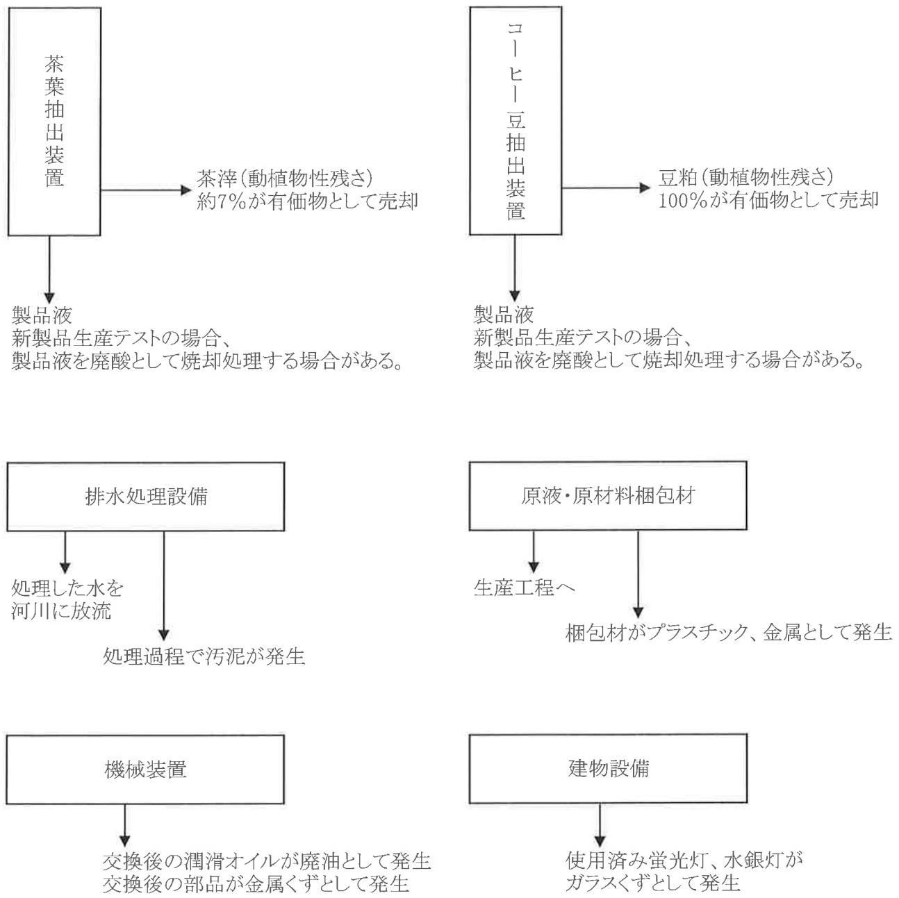
※プラスチック・金属の分別が出来ない機械設備、建物設備が安定型混合廃棄物として発生。
