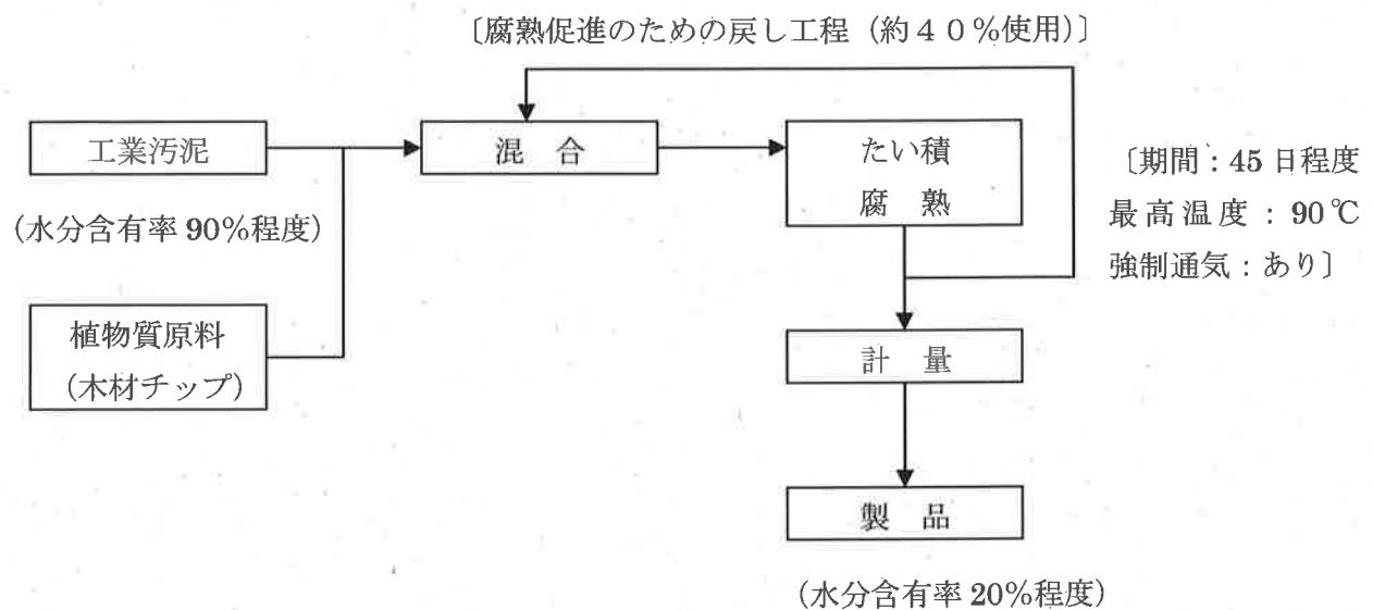
図 2 高速堆肥化処理施設フローシート
