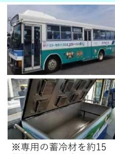
※専用の蓄冷材を約15個使用し、温度を0°C ~8°Cに保ちます。
