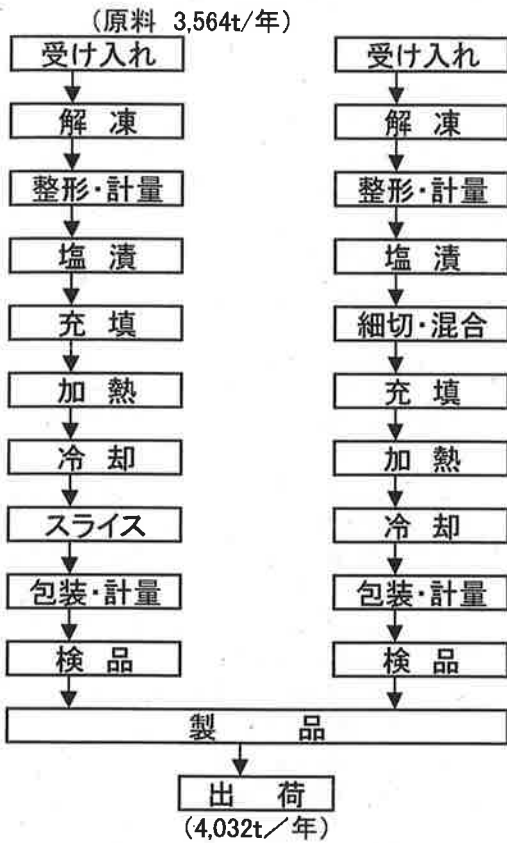
図1 ハム・ソーセージ製造フローシート (製造・特需工場)
