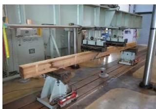
心去り材の曲げ試験
