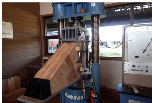
CLT耐力壁の圧縮試験
