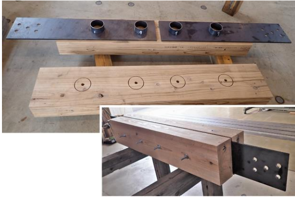
図2 接合金物（試験用に製作）
