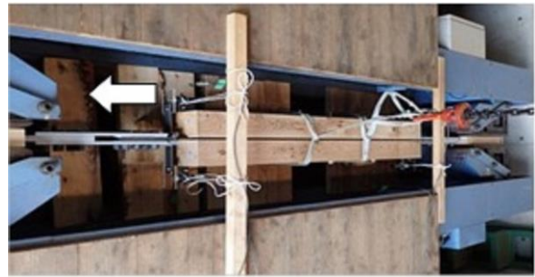
図4 引張試験状況
