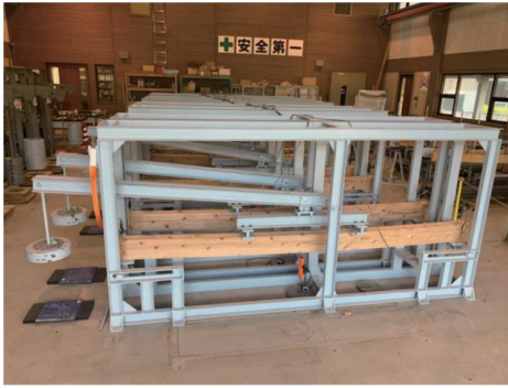
構造材の曲げクリープ試験
