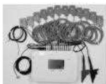
オンライン診断を実現する太陽光発電設備の劣化診断装置を開発
