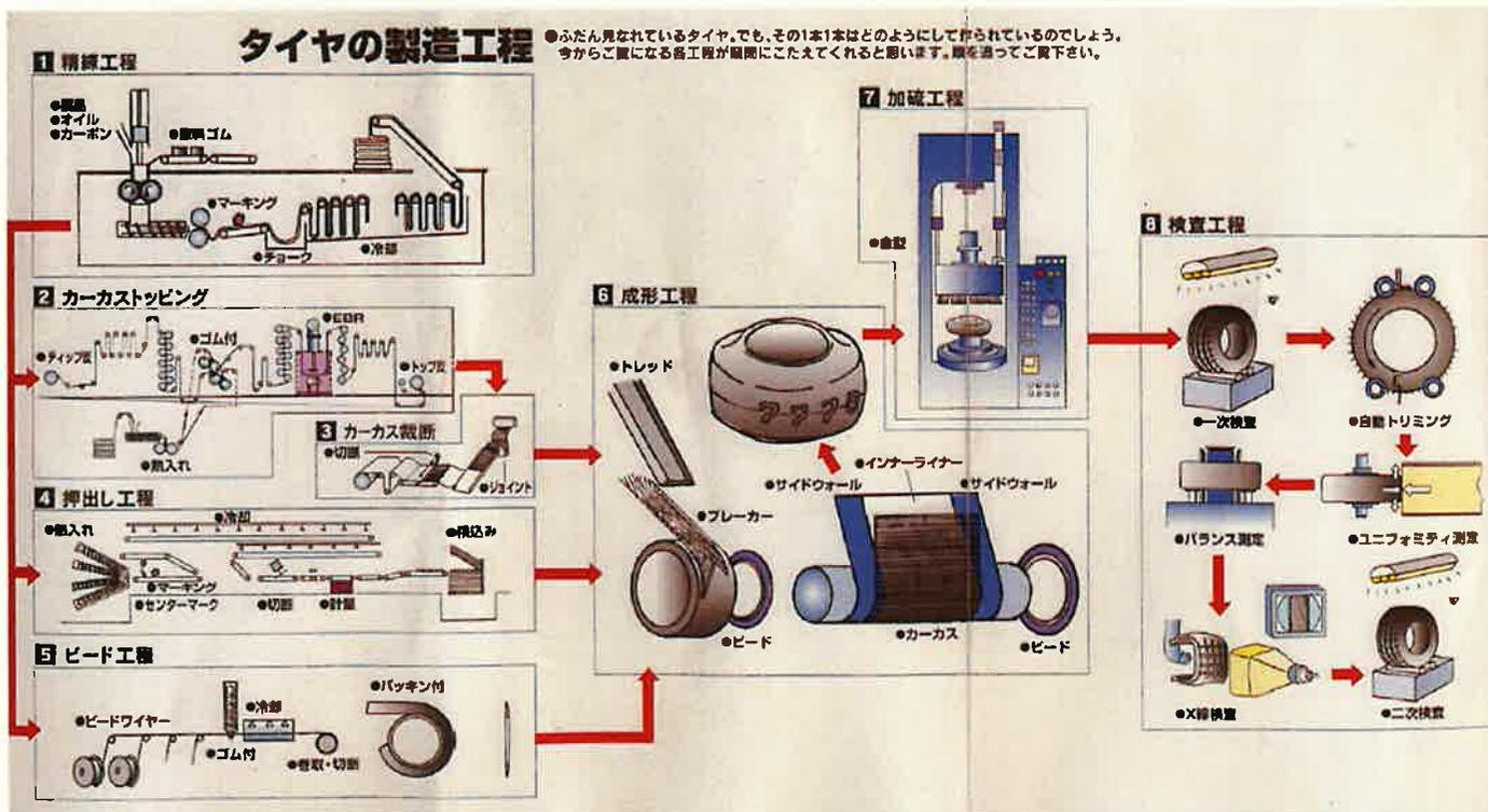
原材料を素材工程(混合、トッピング、押出、ビード)で加工し、成形工程で組み立て、加硫工程で金型に熱と圧力を加えて弾力のある製品タイヤとなる。
