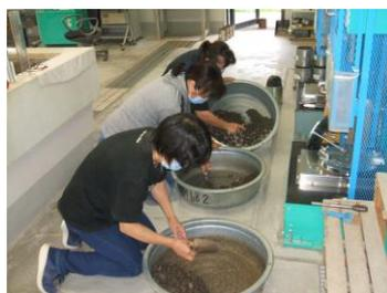
突き固め試験 (加水状況)
