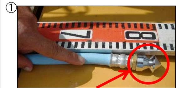
① 逆噴射用洗管ノズル(φ10mm)
