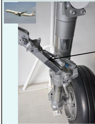
高度な技術が要求される降着部品の製造
