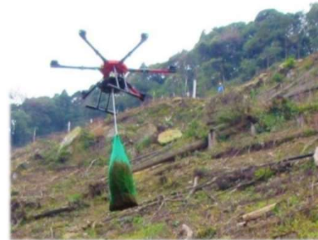
ドローンによる苗木運搬
