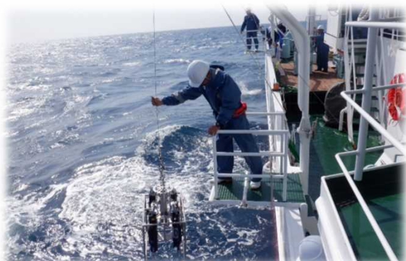
〈写真〉CTD採水器による海洋観測
