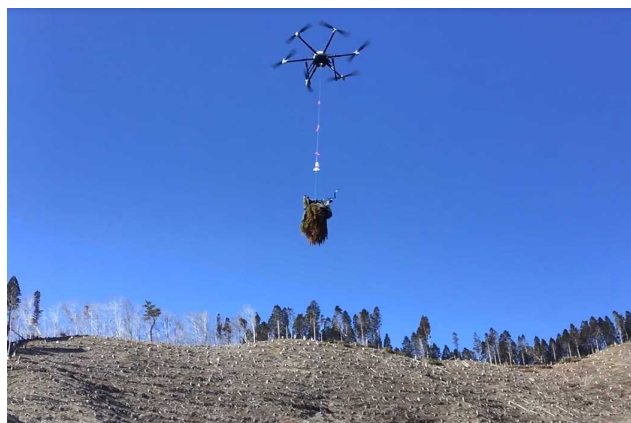
運搬用ドローンによる苗木運搬
