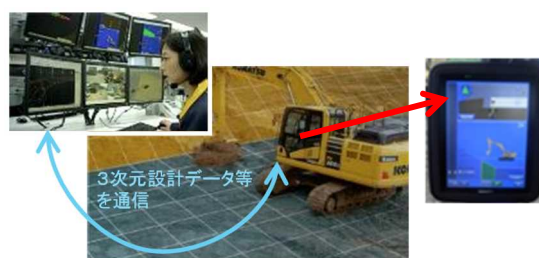
(ICT建設機械による施工)
