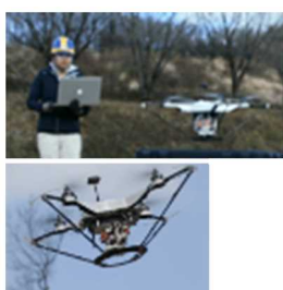
(ドローン等による3次元測量)
