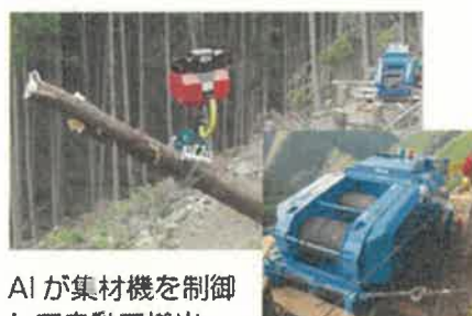
遠隔操作やAI制御が可能な油圧・電子式の集材機
