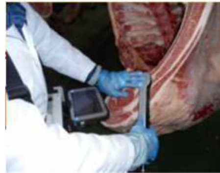
光学測定装置による脂肪酸のデータ収集
