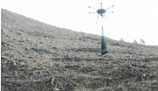
ドローンによる苗木運搬
