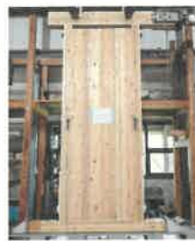
MLT耐力壁 壁倍率4.7倍
