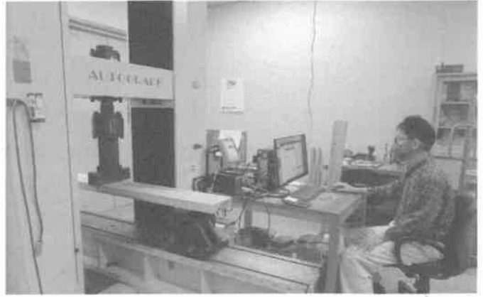
スギ材曲げ試験状況
