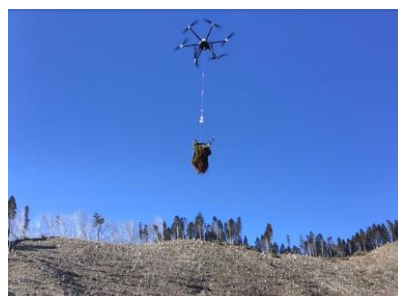
運搬用ドローンによる 苗木運搬
