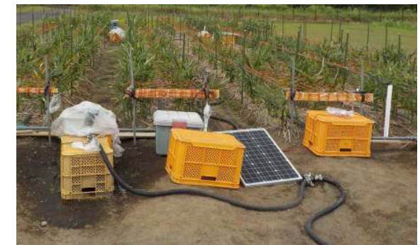
図5 ソーラーバッテリーによる自動かん水装置
