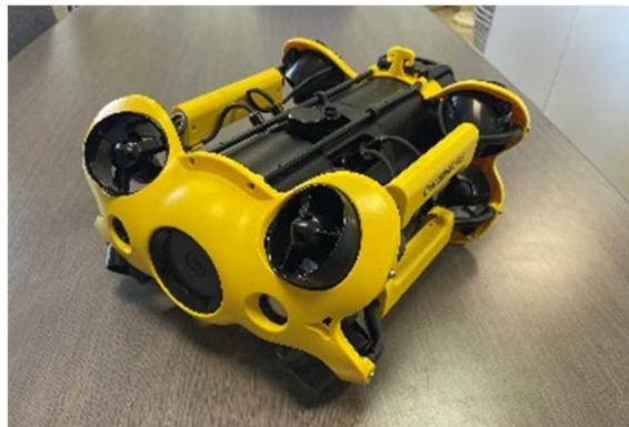
図5 藻場モニタリングへの水中ドローン活用
