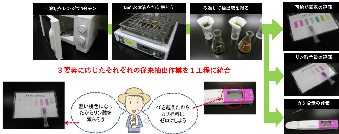
図4 電子レンジ等を用いた可給態窒素の簡易分析手法
