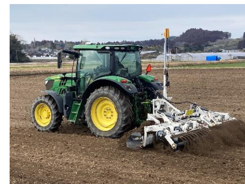
レーザーレベラー
