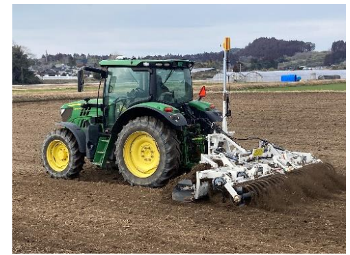
レーザーレベラー
