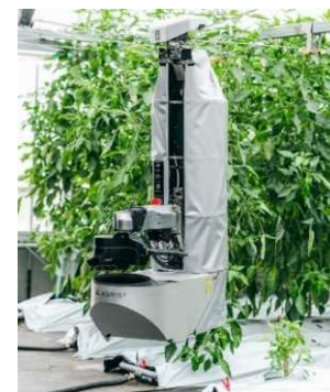
ピーマン自動収穫ロボット
