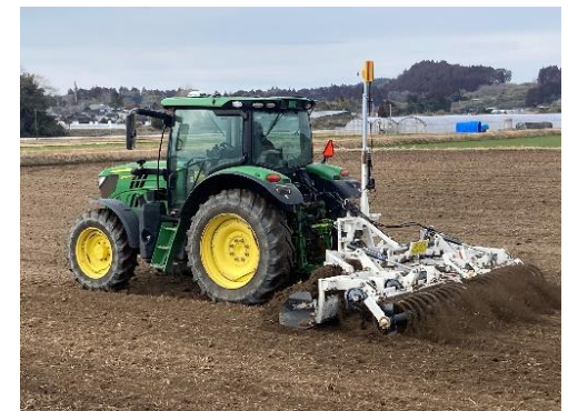
レーザーレベラー
