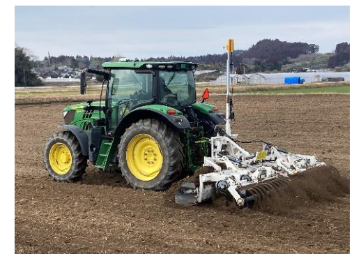
レーザーレベラー
