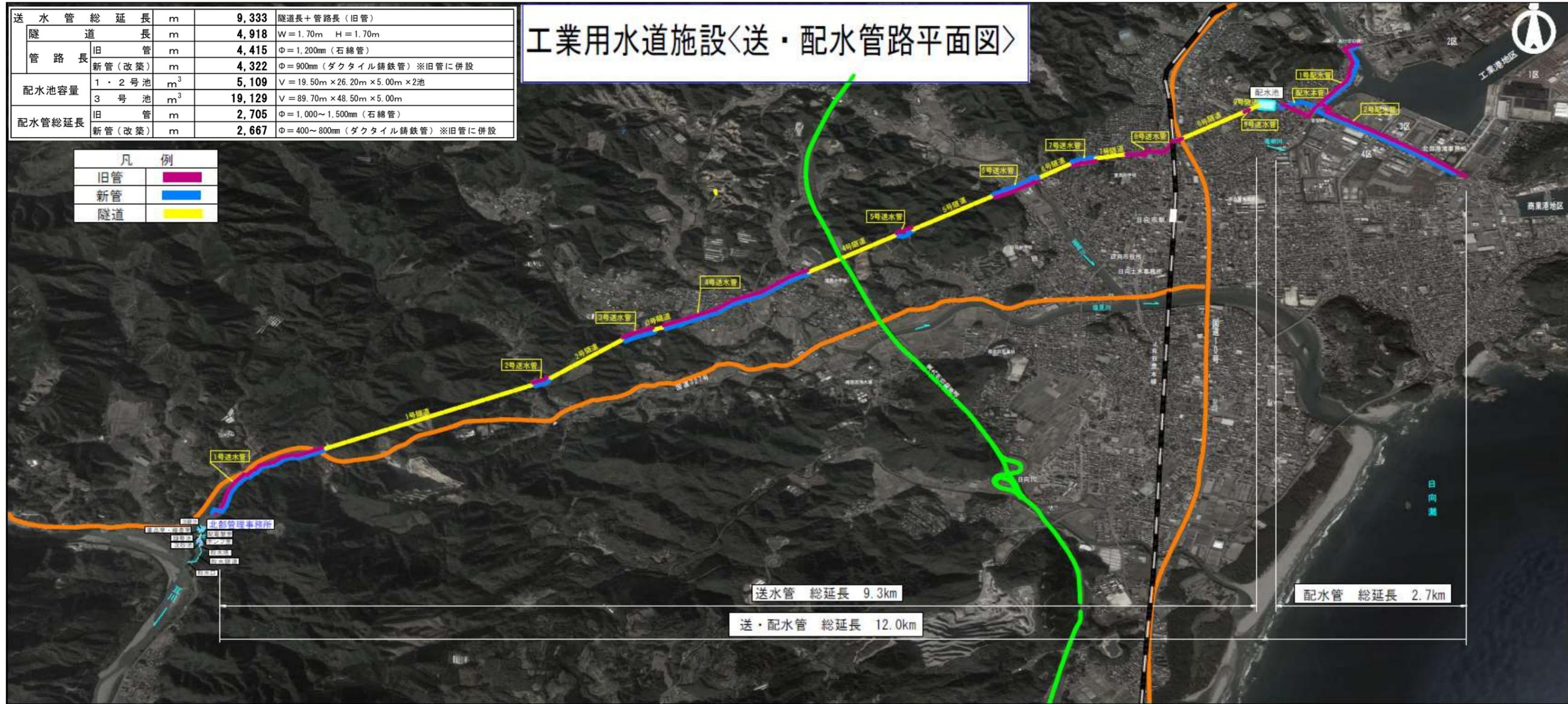
図3 送・配水管路平面図
